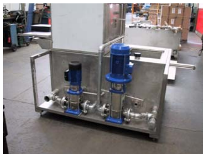
Rotor 60 Doppelbad mit Pumpeneinheit 2,5 + 8 bar (Ansicht ohne Verkleidungsbleche)
