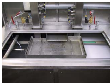
Rücklauf mit Filterkasten (2-Bad-Anlage)
